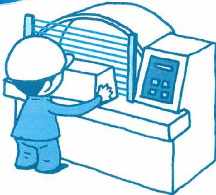
ตัวอย่าง: อุปกรณ์ความปลอดภัยของเครื่องจักรบรรจุหีบห่อ
